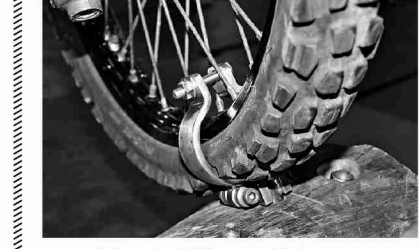
削った切株と手製金具に固定された前輪
