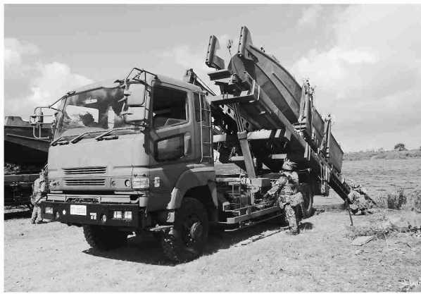
浮橋の架設準備
