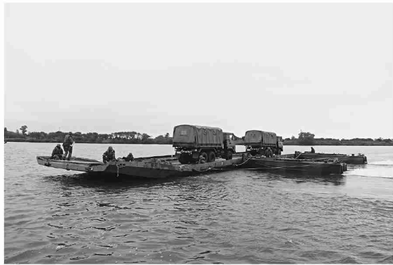
92式浮橋による渡河作業(第101施設器材隊)
