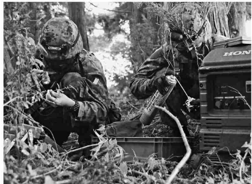
発電機を整備する隊員
