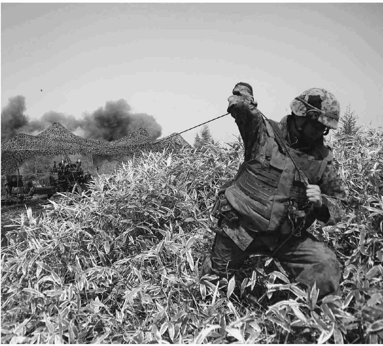
FH-70のりゅう縄射撃(安全確認のための引き網を使用した射撃)
