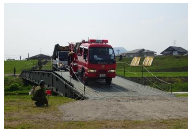
07式機動支援橋 (消防車の通過【防災訓練】)
